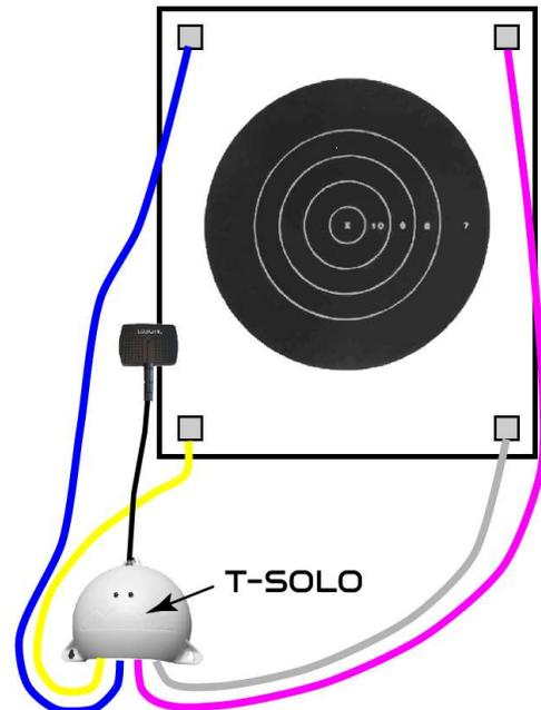
**ANTENNAS MUST BE ATTACHED WHENEVER POWER IS APPLIED. ATTACH ANTENNAS BEFORE POWER, REMOVE POWER BEFORE ANTENNAS.**
